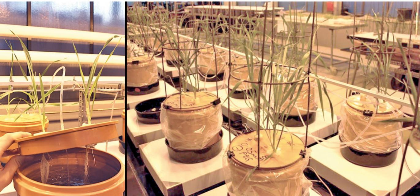
Im Gewächshaus des IAPN werden Pflanzen in Nährlösung (links) kultiviert, da so eine exakte Kontrolle der Nährstoff- und Wasserversorgung möglich ist. Durch die Waagen (rechts) ist eine genaue Bestimmung des Wasserverbrauchs möglich. (Fotos: Jákli)
